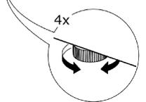
Перед установкой газлифта необходимо открутить гайки, снять шайбы с посадочного места газлифта.
