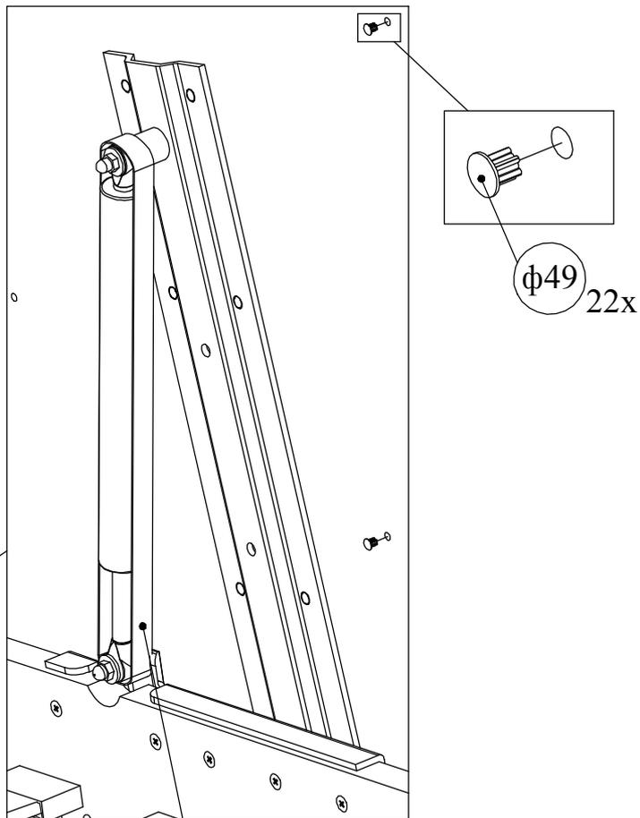
Навесить газлифт на подъемный механизм снизу штоком вниз, установить снятые шайбы, закрутить гайки. Подняв короб кровати примерно на 30 градусов, установить газлифт в верхней части и закрепить его тем же способом. **После этого можно удалить натяжную ленту с газлифта и сохранить её!**
